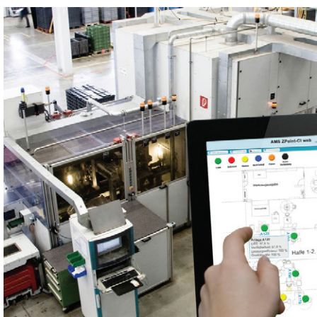
Система управления производственным помещением компании STIWA, основанная на MATLAB, AMS ZPoint-CI и AMS Analysis-CI.
