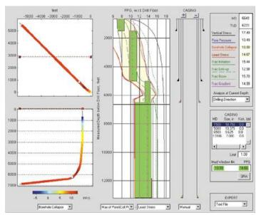
Один из интерфейсов комплекса GMI для буровых инженеров по определению оптимальной плотности бурового
