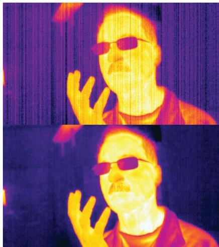
Необработанное изображение (сверху) и изображение после применения фильтра, разработанного в HDL Coder (снизу).
