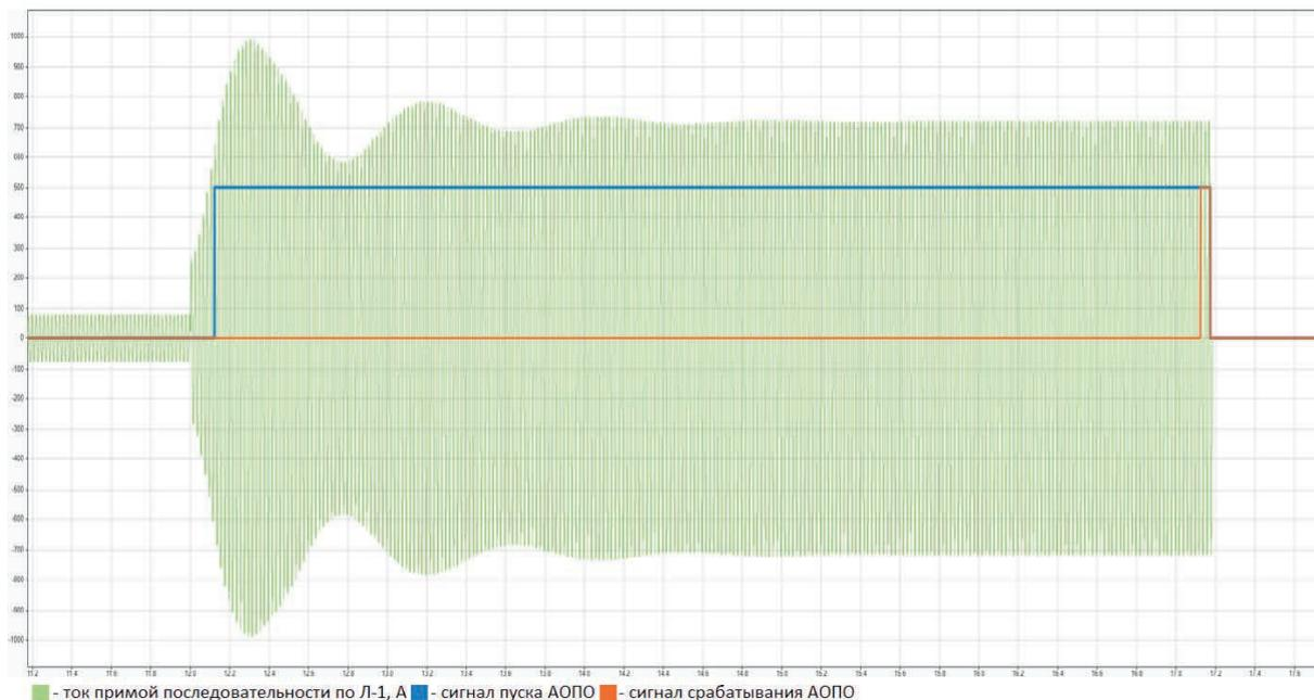
**Рис. 7.** Осциллограмма испытания АОПО
