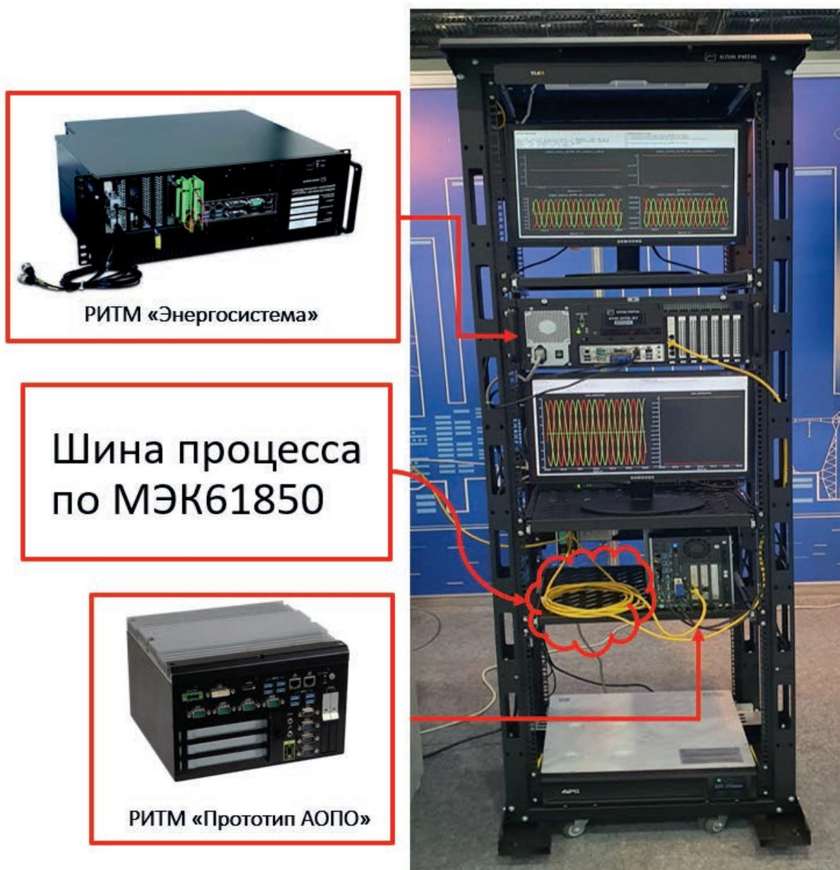
**Рис. 6.** Реализация стенда цифровой подстанции
